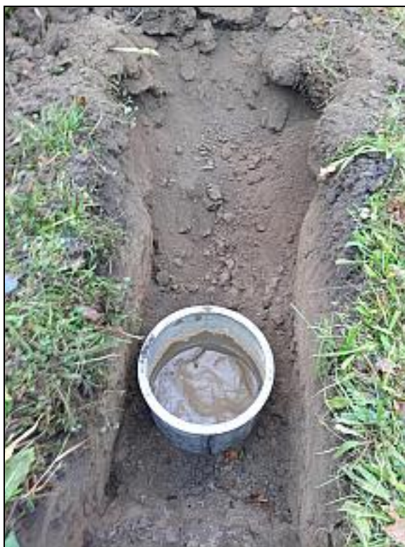
Vsakovací zkouška na vsakovací sondě VS-2
