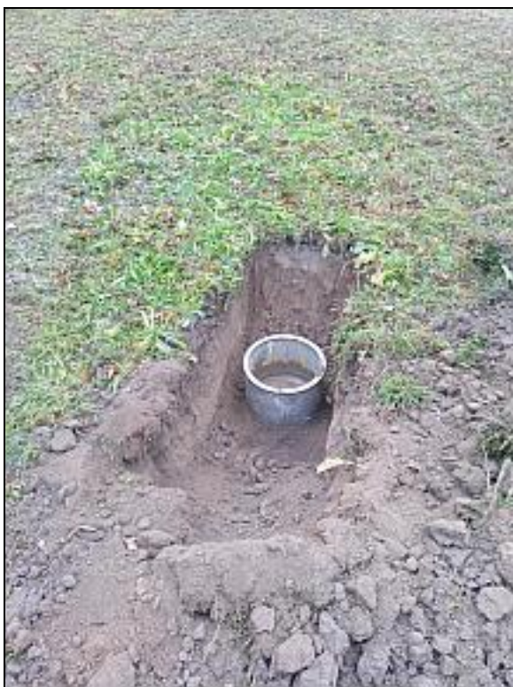
Vsakovací zkouška na vsakovací sondě VS-2
