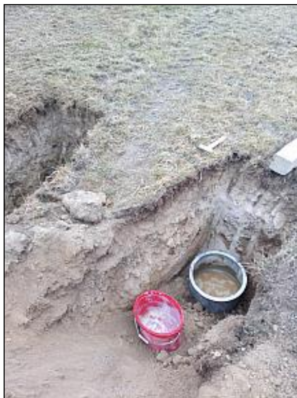
Vsakovací zkouška na vsakovací sondě VS-1
