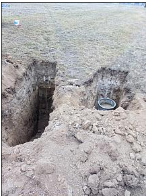
Vsakovací zkouška na vsakovací sondě VS-1
