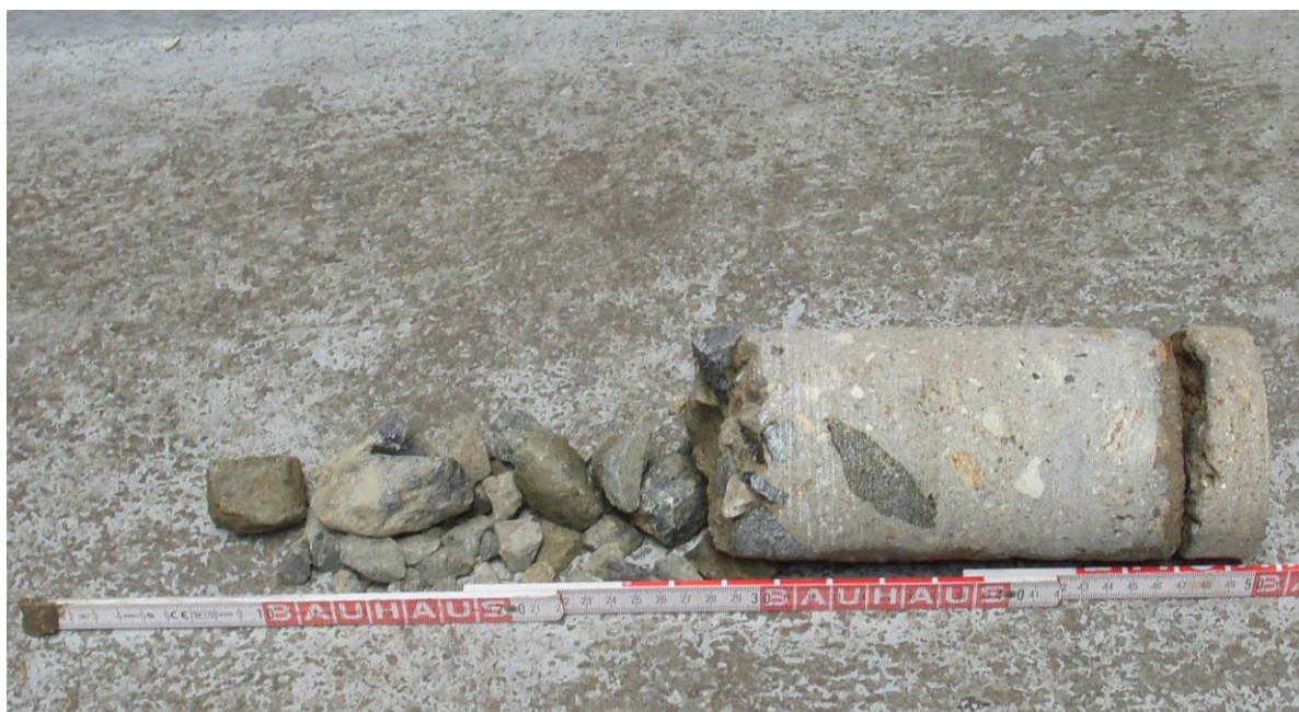
9...jádrový vývrt sondy S1 k spodní železobetonové desce
