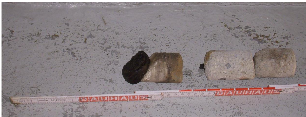
5... Jádrový vývrt sondy S2 k hydroizolaci
