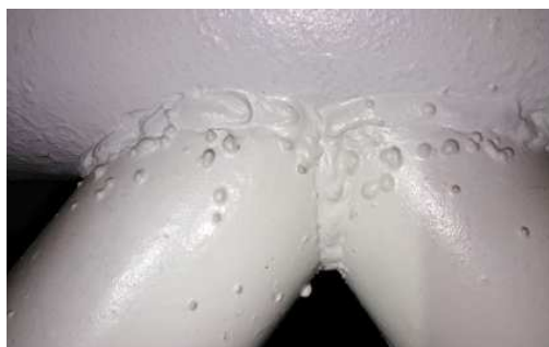
OBR: 13 – Rozstřík svarového kovu
