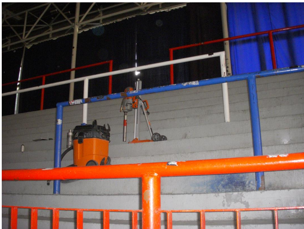
3...pohled na vrtací zařízení u sondy S2
