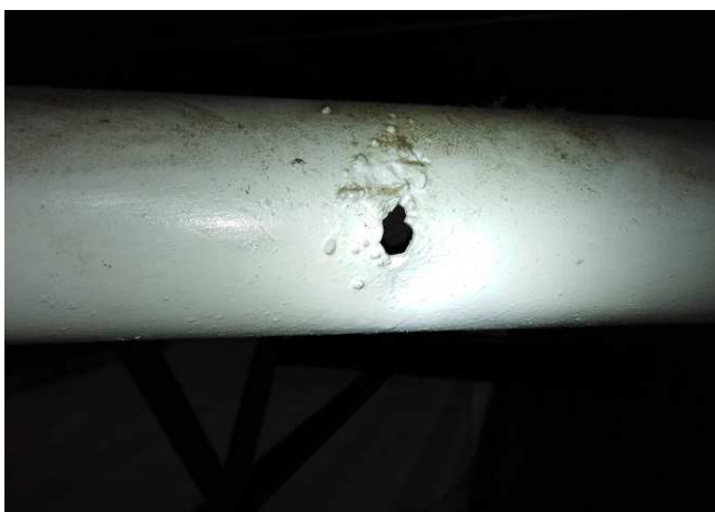
OBR: 22A – Vylomená část stěny trubky ztužení / 22B – Neuzavřený svar
